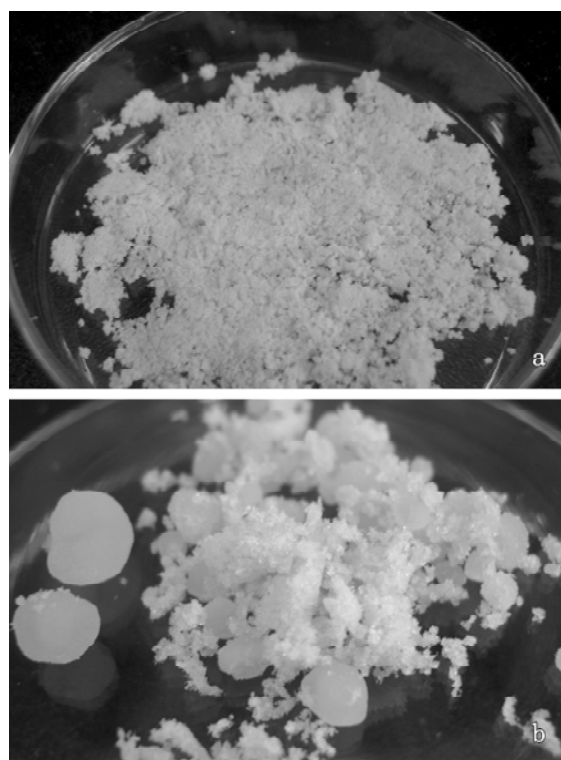
图1 两种继代方法得到的烟草悬浮细胞 a: 改进的方法; b: 普通的方法。
